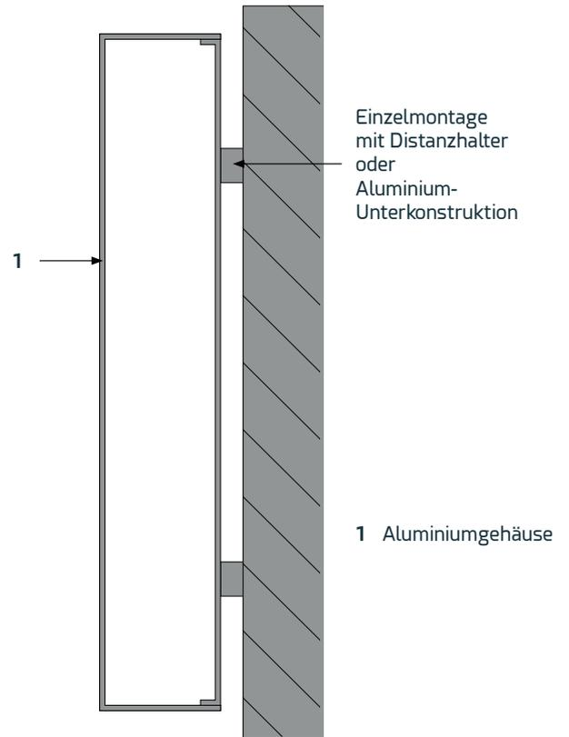
Rückplattenwanne aus Aluminium, welche mit einer Aluminiumhaube bestückt ist. Die gesamte Aluminiumhaube inkl. Zargen bzw. Seitentiefe wird in RAL-Farbe nach Wahl, 2K lackiert. Die Einzelbuchstaben werden mit einer Distanz von 20mm, auf die Gebäudewand aufgesetzt.
