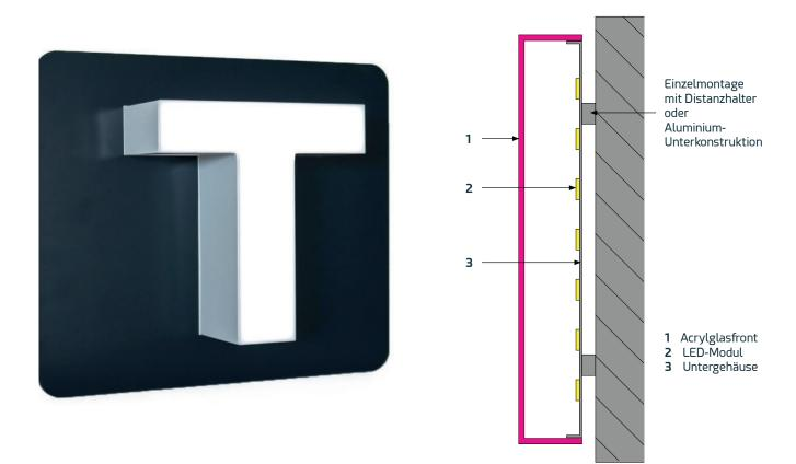
Rück- bzw. Trägerplatte aus Aluminium, welche mit einer Acrylglashaube bestückt ist. Die Front bzw. der Spiegel aus Acrylglas Farbe Perspex® nach Wahl, leuchtend ausgeführt. Die Zargen bzw. Seitentiefe wird nicht leuchtend, deckend in RAL-Farbe nach Wahl 2K lackiert.
