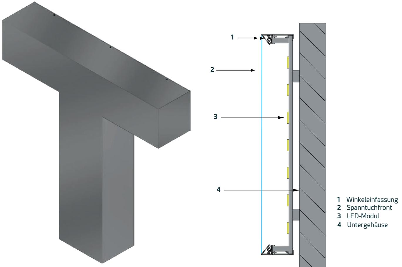
Rückplattenwanne aus Aluminium, welche einseitig mit einem Spannprofil bestückt ist. Die Einfassung erfolgt durch einem umlaufenden Aluminiumwinkel, welcher seitlich verschraubt ist. Die Front wird mittels einen Spanntuch aus 8C digital bedrucktem & UV-schutzlackiertem Hochleistungs-Backlit PVC-Spannmembran gefertigt, welches umlaufend mit Tuchhalter bestückt ist & formstabil bzw. faltenfrei gespannt wird.
